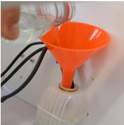
Débrancher la sortie de la pompe du capteur thermique pour amorcer la pompe (débrancher la durite noire)
