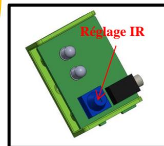
Vous pouvez régler la LED infrarouge en fonction de la luminosité de la pièce à l'aide du potentiomètre sur le circuit récepteur IR. Faire en sorte que lorsque l'on coupe la barrière Infrarouge, la led rouge située à côté s'allume.
